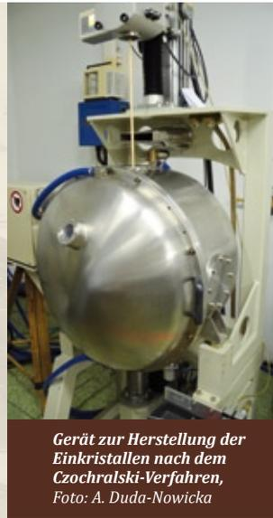
Gerät zur Herstellung der Einkristalle nach dem Czochralski-Verfahren, Foto: A. Duda-Nowicka
