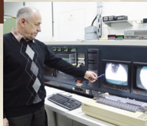
Aparatura kontrolna z podglądem na wzrost monokryształów otrzymywanych metodą Czochralskiego, fot. A. Duda-Nowicka
