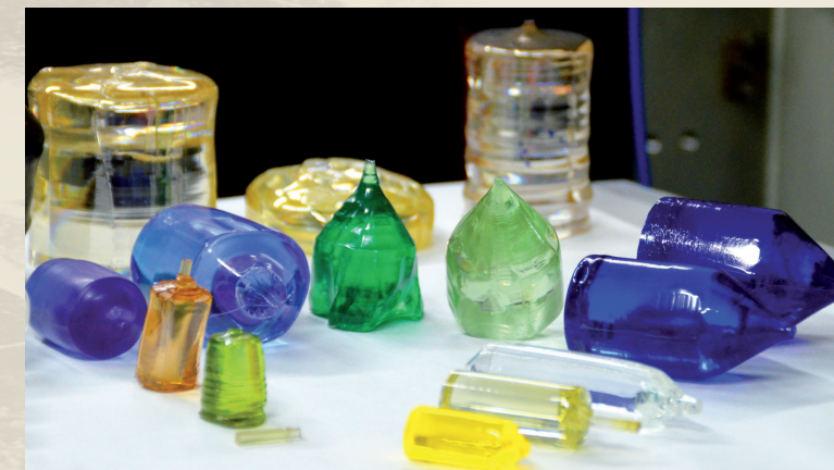
Monokryształy uzyskane metodą Czochralskiego, fot. A. Duda-Nowicka
