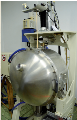
Urządzenie do otrzymywania monokryształów metodą Czochralskiego, fot. A. Duda-Nowicka
